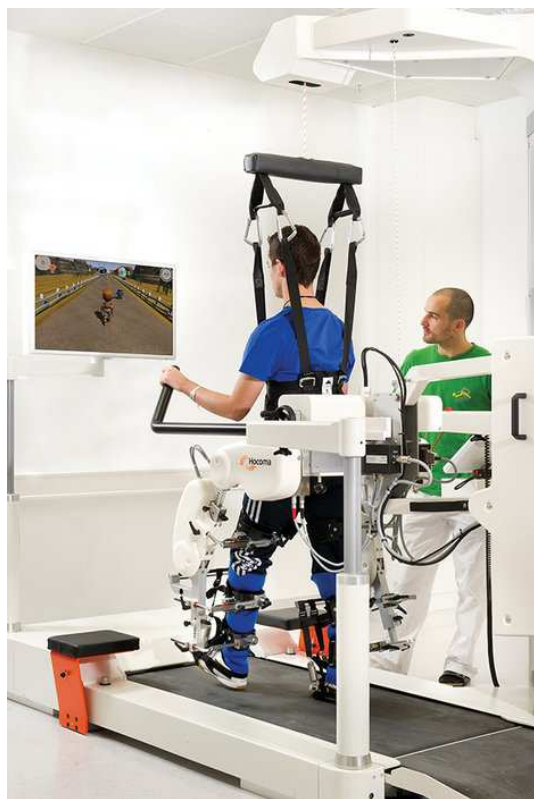
Abbildung 17: Rehabilitationsrobotik: Robotische Gangtherapie in einem „Lokomat“. © Hocoma, Schweiz
